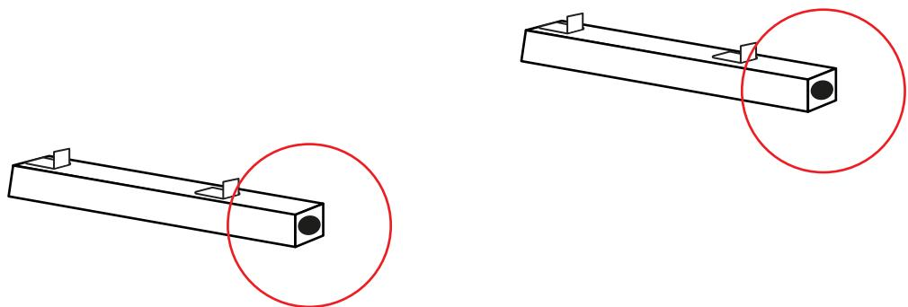
Appoggia i montanti sul pavimento. Per assicurarti un corretto montaggio, verifica la posizione dei feltrini di appoggio.
