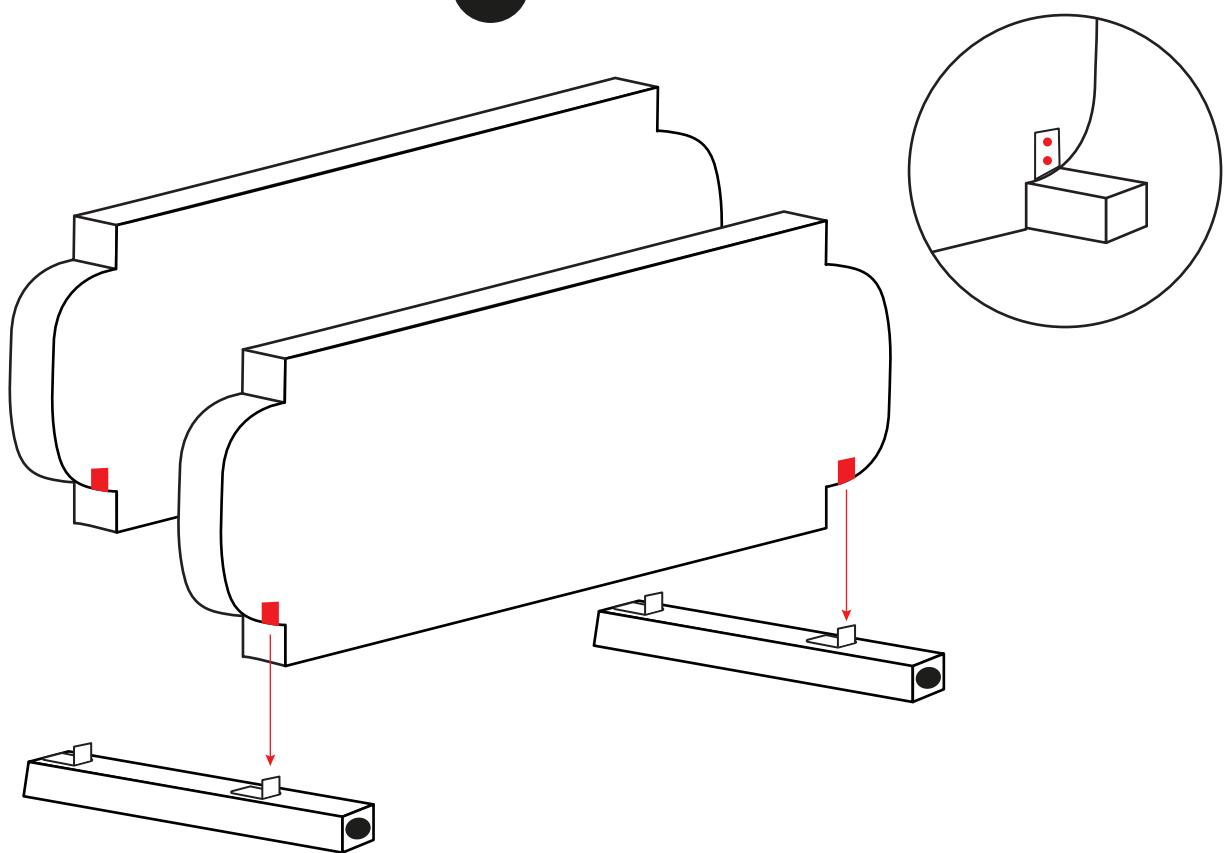
Inserisci una mensola per volta, facendo coincidere la tasca con la staffa inserita nei montanti. Poi fissala con le viti in dotazione.
